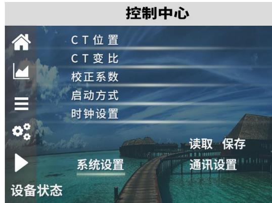
进入系统参数设置后, 设置 CT 位置: 0 依据实际情况选择系统侧或负载侧; CT 变比: 比如 2000/5,则设置 400; 校正系数: 每台模块系数之和; 启动方式: 断电自启动方式, 自动或手动; 时钟设置: 日期及时间设置
