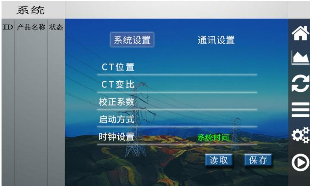
进入系统参数设置后, 设置CT位置: 0依据实际情况选择系统侧或负载侧; CT变比: 比如2000/5,则设置400; 校正参数: 每个模块参数之和; 启动方式: 断电自启动方式, 自动或手动; 时钟设置: 日期及时间设置。
