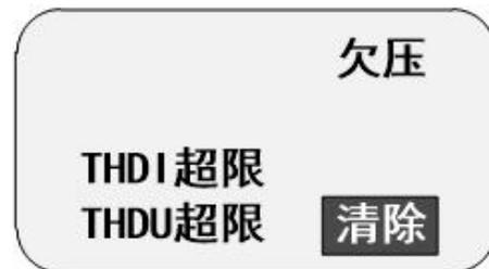
某项参数超限或者不达标, 会造成控制器报警(右上角显示喇叭符号), 报警后控制器会对已经投入的回路进行切除, 并闭锁控制器输出, 需要查看具体的报警后针对性调整某项参数以后控制器才可以正常运行。
